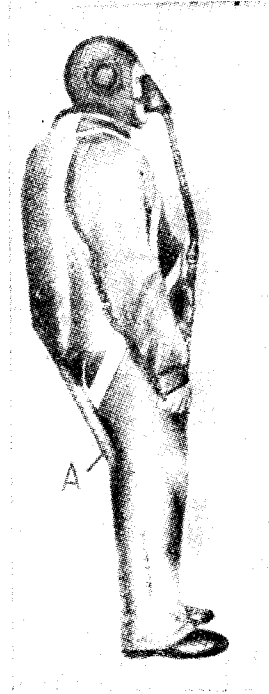
14. ábra. A zsebben elhelyezett KP-23 légző- készülék felvett hát- ernyőnél (oldalnézet) A — zseb a KP-23 légzőkészülékkel.
